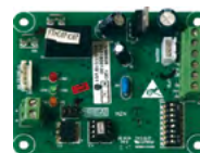
Согласователь работы двух кондиционеров YCJ-A002*
