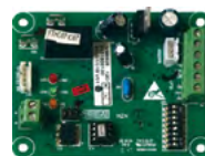
Согласователь работы двух кондиционеров YCJ-A002*
